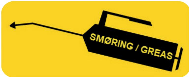
Jeder Bereich, der geschmiert werden muss, wird mit dem obigen Aufkleber gekennzeichnet.
