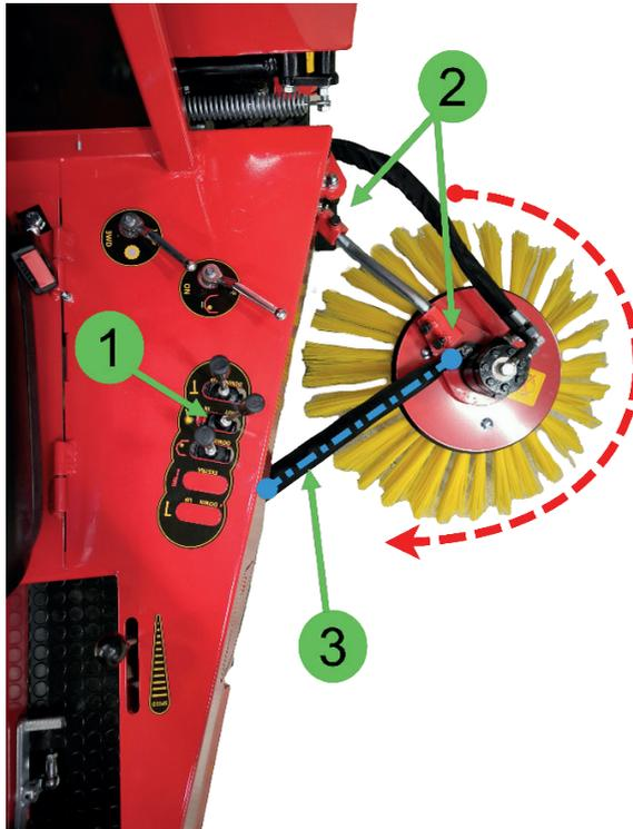
1. Drücken Sie den Hydraulikhebel Nr. 5 nach vorne, um die Bürstenfunktion zu aktivieren. Dadurch wird der Arm herausgezogen und die Rotation der Bürste gestartet. Der Ventilhebel hat eine Sperrfunktion, die einen kontinuierlichen Ölfluss in das Hydrauliksystem gewährleistet. Ziehen Sie den Hydraulikhebel zurück, um die Bürste zu entriegeln und den Arm in die eingeklappte Position zu bringen.
