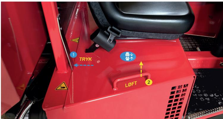
1. Drücken Sie gleichzeitig auf den Sicherheitsverschluss (auf der linken Seite der Motorabdeckung) und (2), während Sie die Abdeckung anheben.
