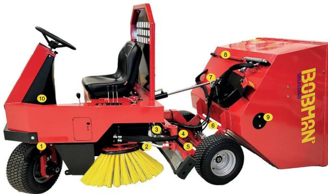
Stellen Sie sicher, dass alle Anschlüsse geschmiert und sauber sind. Das richtige Schmierintervall hängt sehr stark von den Betriebsbedingungen ab. Die Notwendigkeit der Schmierung sollte mindestens alle 10 Betriebsstunden überprüft werden. Wenn die Gelenke verschmutzt sind, fügen Sie Schmiermittel hinzu. Stellen Sie sicher, dass die Anschlüsse ordnungsgemäß geschmiert sind. Eine unzureichende Schmierung führt zu einem schnellen Verschleiß der Gelenke.
