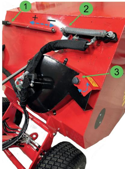
Drehen Sie den Hebel Nr. 2 im Uhrzeigersinn, bis er die Position „ON“ erreicht, um das Gebläse und die Schnecke einzuschalten.
