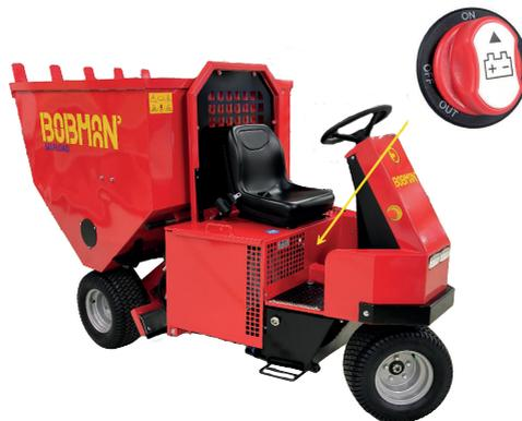
1. Drehen Sie den Hebel nach rechts in die Position ON – Die Batterie ist nun mit dem elektrischen System verbunden.
