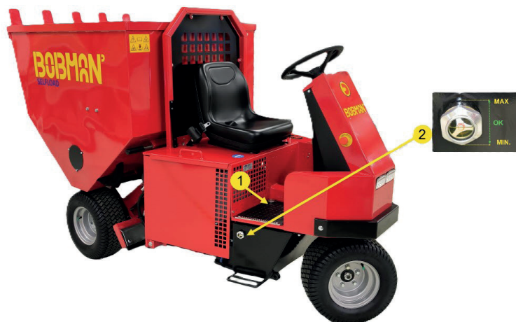
(1) Dækslet til hydraulikoliens tank. / (2) Oliestandsindikatoren
