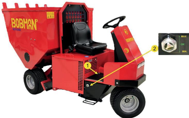
(1) Tapón del depósito de aceite hidráulico. / (2) Indicador de nivel de aceite
