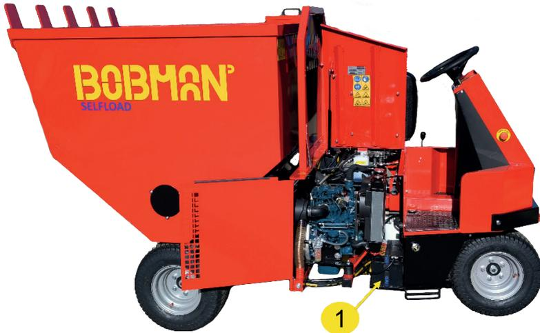
**Vérifiez l'état et le serrage de la batterie, de l'interrupteur principal de la batterie et des câbles.**
