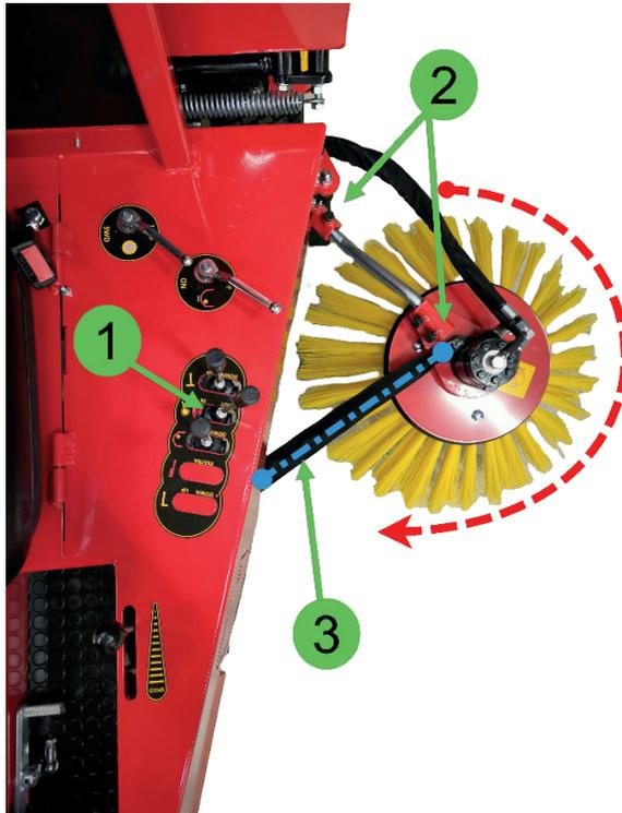
1. Poussez le levier hydraulique 5 vers l'avant pour activer la fonction de brossage. Cela permet d'avancer le bras et de mettre la brosse en rotation. Le levier de la valve a une fonction de verrouillage qui assure un flux continu d'huile dans le système hydraulique. Tirez le levier hydraulique vers l'arrière pour désengager la brosse et ramener le bras en position repliée.
