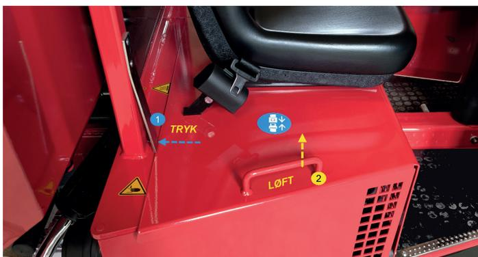
1. Appuyez simultanément sur le loquet de sécurité (situé sur le côté gauche du couvercle du moteur) et (2) tout en soulevant le couvercle.
