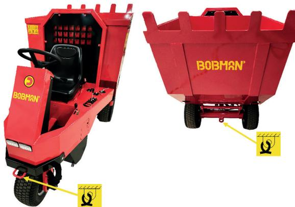
Une machine mal fixée risque de se renverser.
