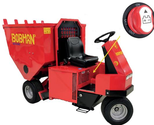
1. Tournez la poignée vers la droite en position ON – La batterie est connectée au système électrique.
