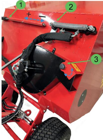
Tournez le levier 2 dans le sens des aiguilles d'une montre jusqu'à ce qu'il atteigne la position « ON » pour mettre en marche la soufflerie et la vis sans fin.
