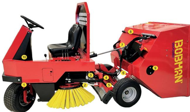
Veillez à ce que toutes les connexions soient lubrifiées et propres. L'intervalle de lubrification approprié dépend fortement des conditions d'utilisation. Le besoin de lubrification doit être vérifié au moins toutes les 10 heures de fonctionnement. Si les articulations sont encrassées, ajoutez du lubrifiant. Veillez à ce que les connexions soient correctement lubrifiées. Une lubrification insuffisante entraîne une usure rapide des articulations.
