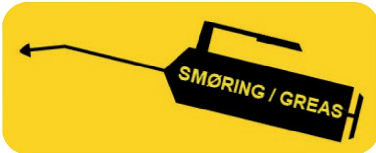
Tout point nécessitant une lubrification sera marqué par l'autocollant ci-dessus.
