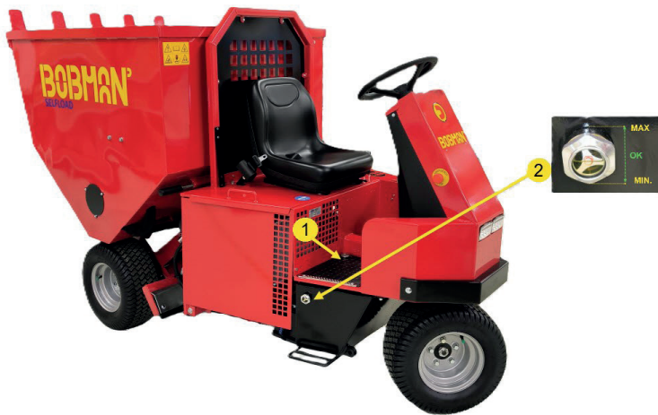
(1) Hidraulika olajtartály beöntőnyílása / (2) Olajszintjelző
