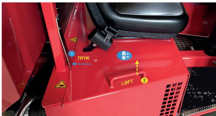
1. Premere contemporaneamente il fermo di sicurezza (posizionato sul lato sinistro del cofano motore) e (2) sollevare il cofano motore.
