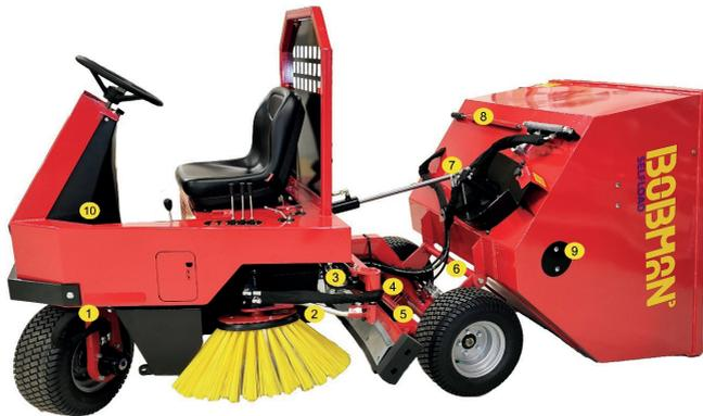
Assicurarsi che tutti i giunti siano ben lubrificati e puliti. L'intervallo di lubrificazione appropriato dipende in larga misura dalle condizioni operative. La necessità di lubrificazione deve essere controllata almeno ogni 10 ore di utilizzo. Applicare lubrificante se i giunti risultano sporchi. È fondamentale garantire una lubrificazione sufficiente dei giunti: una lubrificazione inadeguata comporta un rapido deterioramento.
