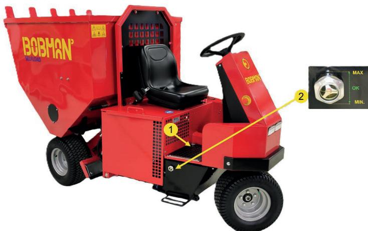
(1) Tappo del serbatoio dell'olio idraulico. / (2) Indicatore del livello dell'olio
