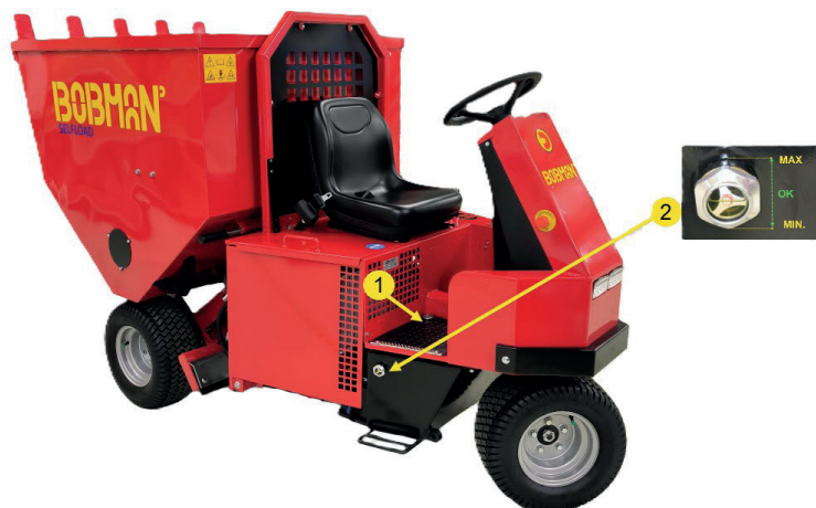
(1) Korek zbiornika oleju hydraulicznego. / (2) Wskaźnik poziomu oleju
